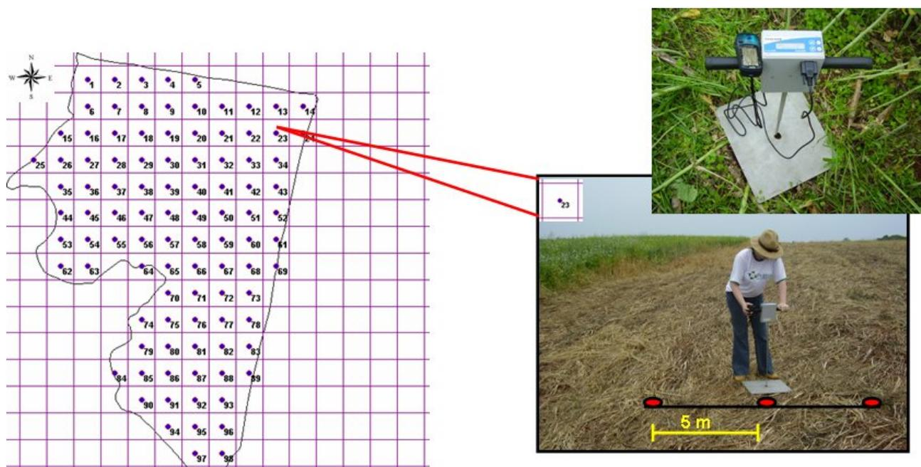
Figura 2 - Monitoramento georreferenciado da compactação do solo utilizando o PenetroLOG.
